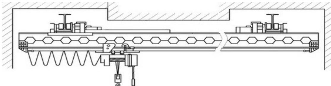
Конструктивно кран состоит из двух основных узлов — моста (балки) с передвигающейся по нему тали, и тележек, на которых он передвигается по крановому пути. В зависимости от грузоподъемности и ширины пролета сечение главной балки может быть различным.
